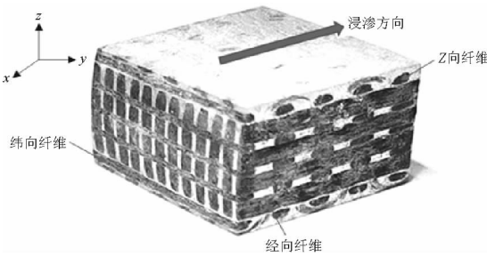
图 5 三维正交结构 M40J/Al 复合材料实物图
